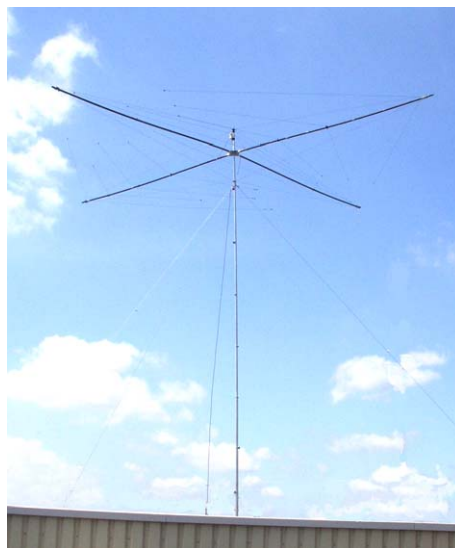
"Спайдер" на 10-метровой алюминиевой выдвигной мачте
